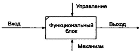
Рис. 3.9. Функциональный блок диаграммы IDEF0
