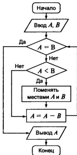
Рис. 1.32. Блок-схема алгоритма Евклида вычисления НОД
