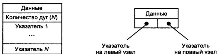
Рис. 1.17. Структура представления узлов и дуг графа:
