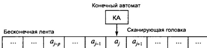
Рис. 2.1. Принципиальная схема абстрактной машины Тьюринга
