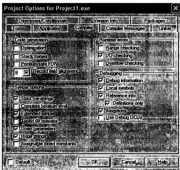
Рис. 4.10. Окно установки параметров проекта
