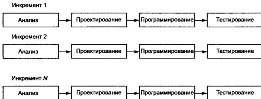
Рис. 3.2. Инкрементная модель ЖЦ
